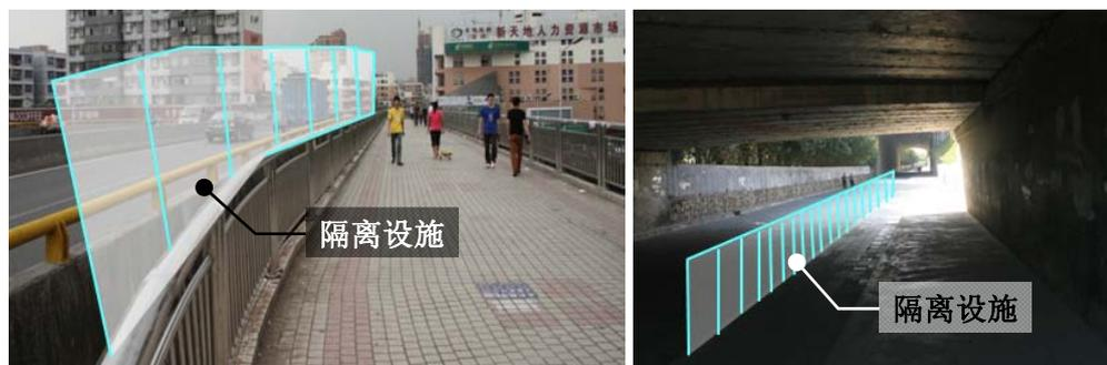
图 4.6.4 人行天桥和地道隔离设施示意图
