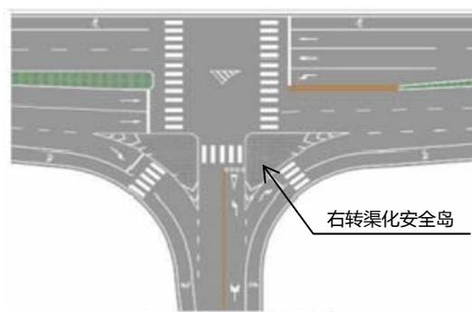
图 4.5.3-2 右转渠化安全岛示意图
