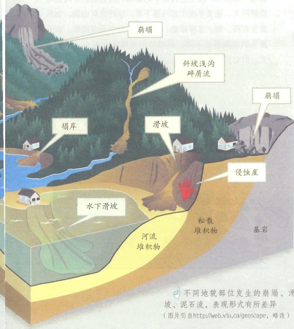
不同地貌部位发生的崩塌、滑坡、泥石流，表现形式有所差异
