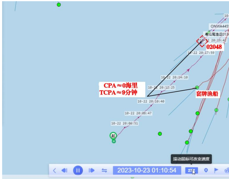
图11: 近海雷达综合监控系统显示0111时两船态势
