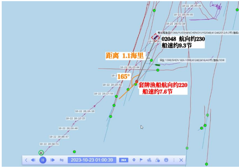
图16: 近海雷达综合监控系统显示0100两船态势
