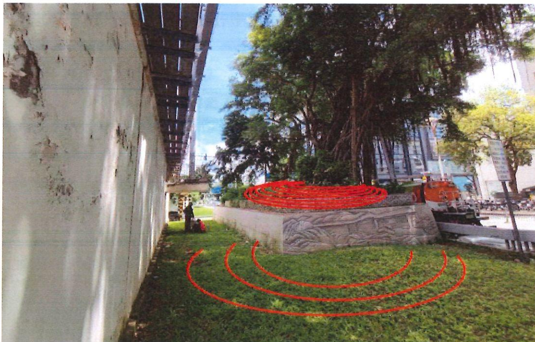
图 编号 44030300302000034 榕树的 Tru 根系检测路径
