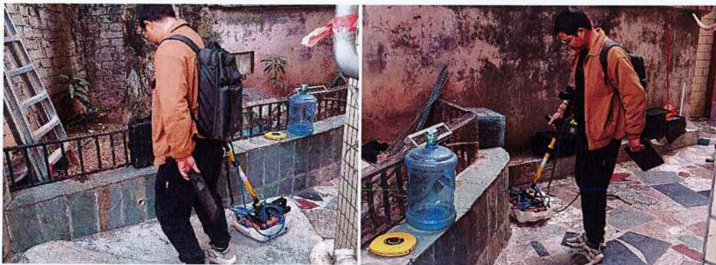
图 4-2 015#古树 TRU 根系检测工作照片
