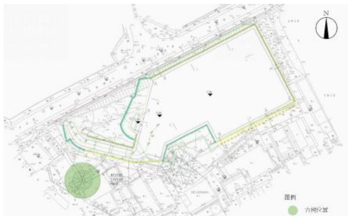
图 1-5·项目基坑支护平面图
