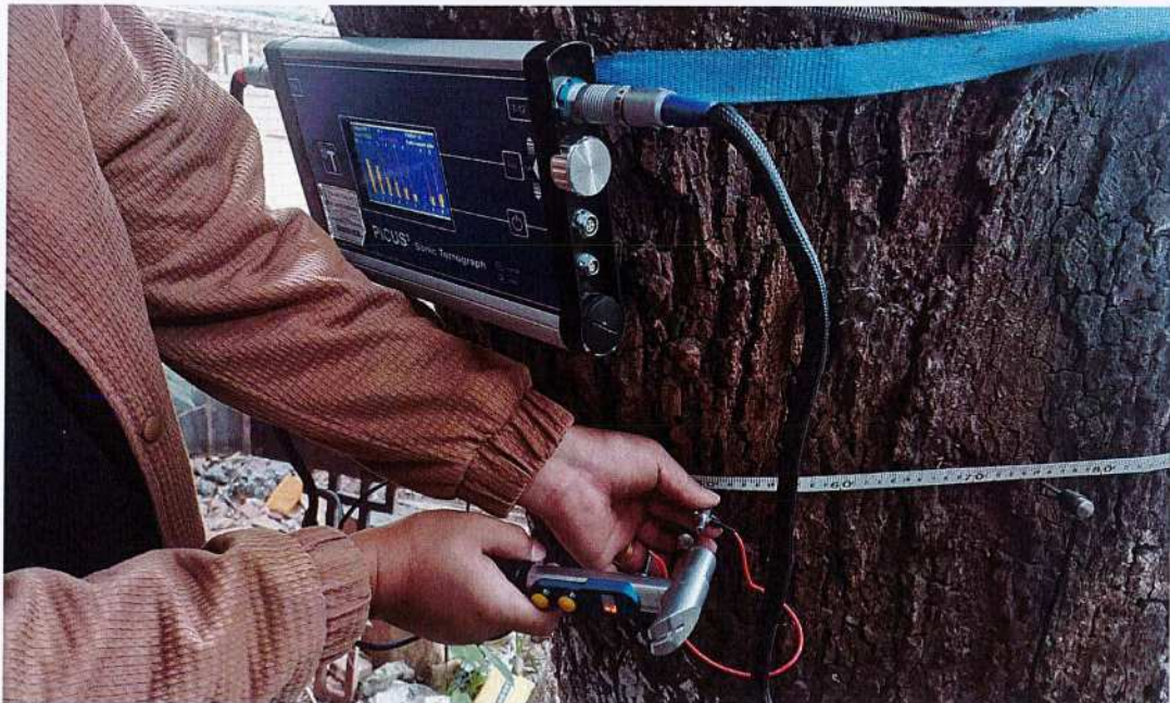
图 4-1 015#古树内部检测工作照片
