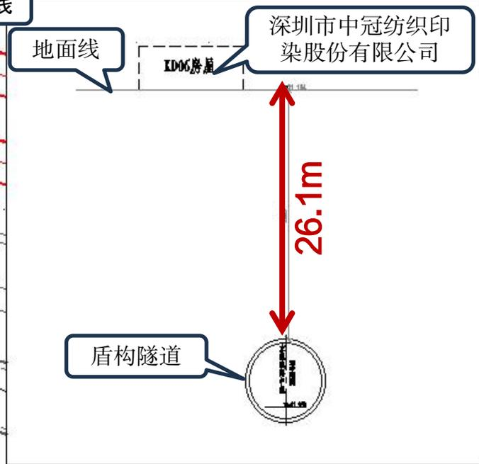
规划轨道交通深惠城际大鹏支线与深圳市中冠纺织印染股份有限公司相交关系纵断面关系图
