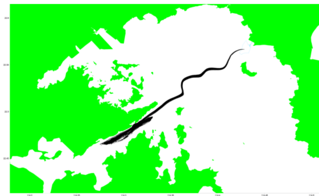
图 4.4.4-2 NE 风向、4.8m/s、大潮落潮时溢油油膜漂移扩散轨迹图
