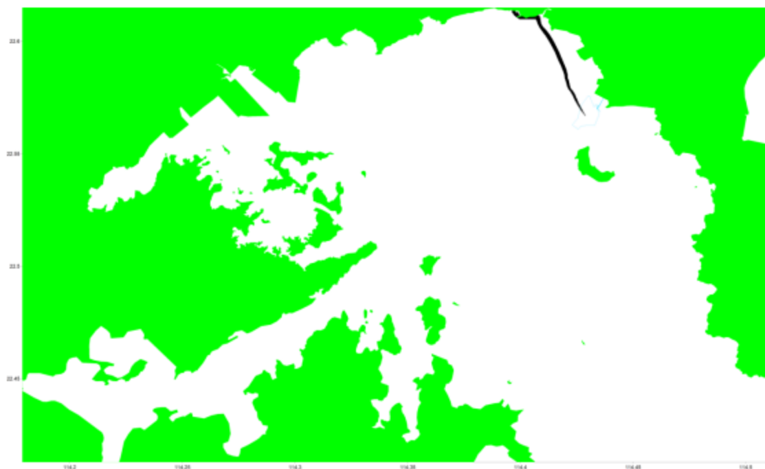
图 4.4.4.4 SSE 风向、4.0m/s、大潮落潮时溢油油膜漂移扩散轨迹图
