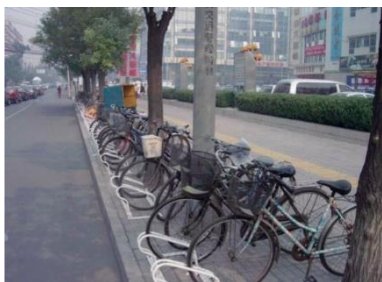
图 8.3.3-1 利用机非分隔带设置
